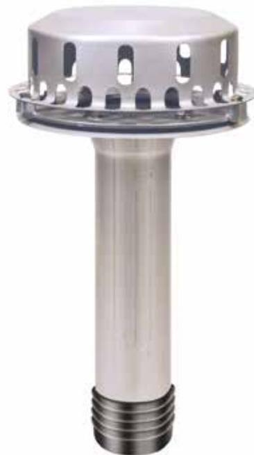
LORO-DRAINLET® Flachdach-Sanierungsabläufe werden beim Einbau einfach durch den bereits vorhandenen Dachablauf bis in das Ablaufrohr hindurchgesteckt.
